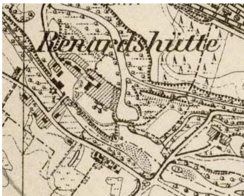
Ryc. 66 Na fragmencie starej mapy widzimy zaporę na Małej Panwi, kanał doprowadzający, mostek, a za nim budynki i plac Renardzkiej huty
